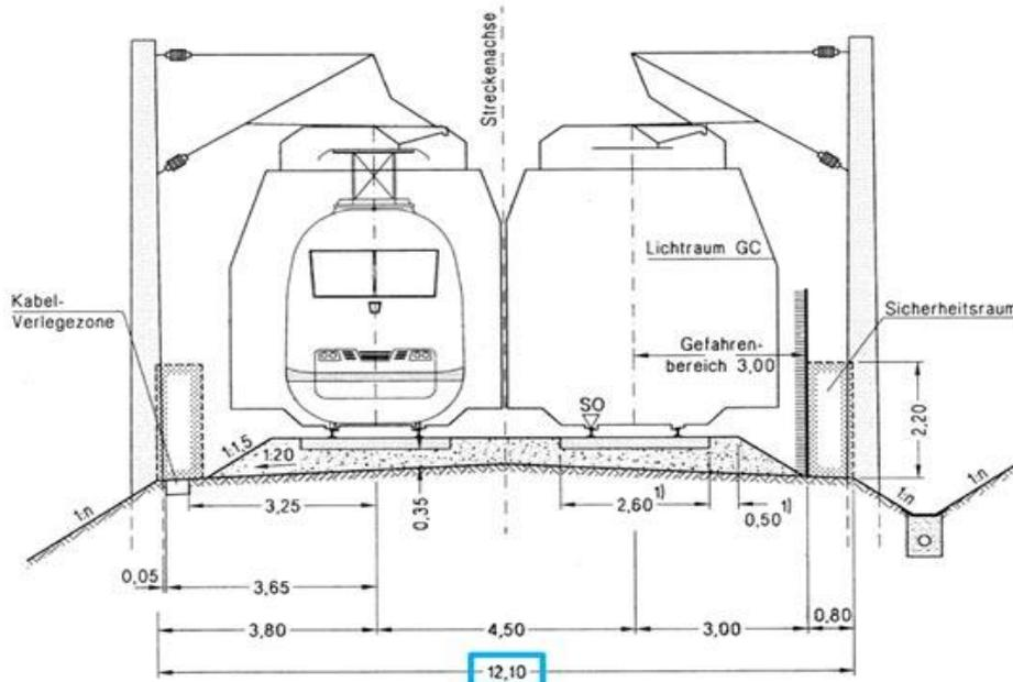
**Abb. 2:** Zweigleisiger Streckenquerschnitt mit 4,50 m Gleisabstand (Quelle: [https://www.wasen-nicht-verbrennen.de/images/vortrag/mg\\_zweigleisig\\_querschnitt.jpg](https://www.wasen-nicht-verbrennen.de/images/vortrag/mg_zweigleisig_querschnitt.jpg))
